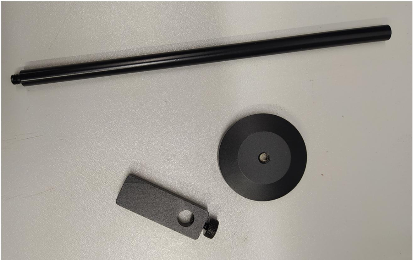
Die Stange wird in die Runde Platte geschraubt. Das rechteckige Stück wird nun mit der kleinen Rändelschraube in der richtigen Höhe an der Stange befestigt, sodass der Halter exakt zwischen die Grafikkarte und den Gehäuseboden passt
