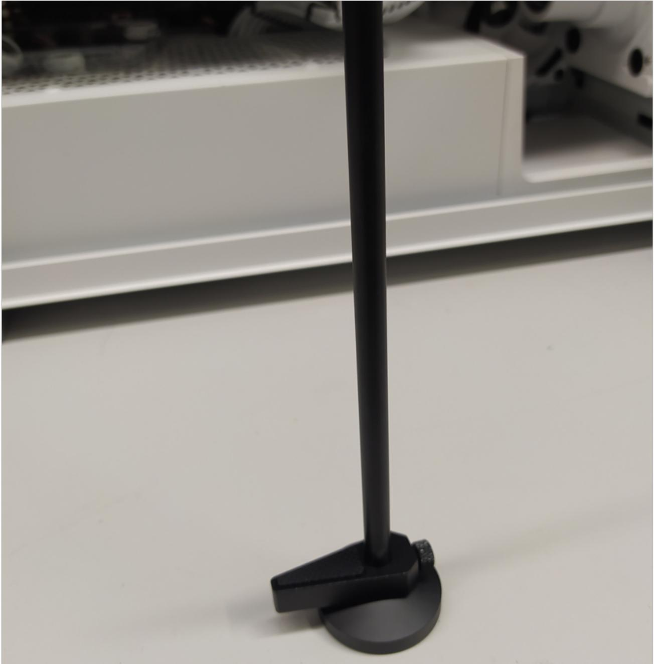
Mit der kleinen Rändelschraube kann man die Höhe anpassen, sodass er exakt zwischen die Grafikkarte und den Gehäuseboden passt
