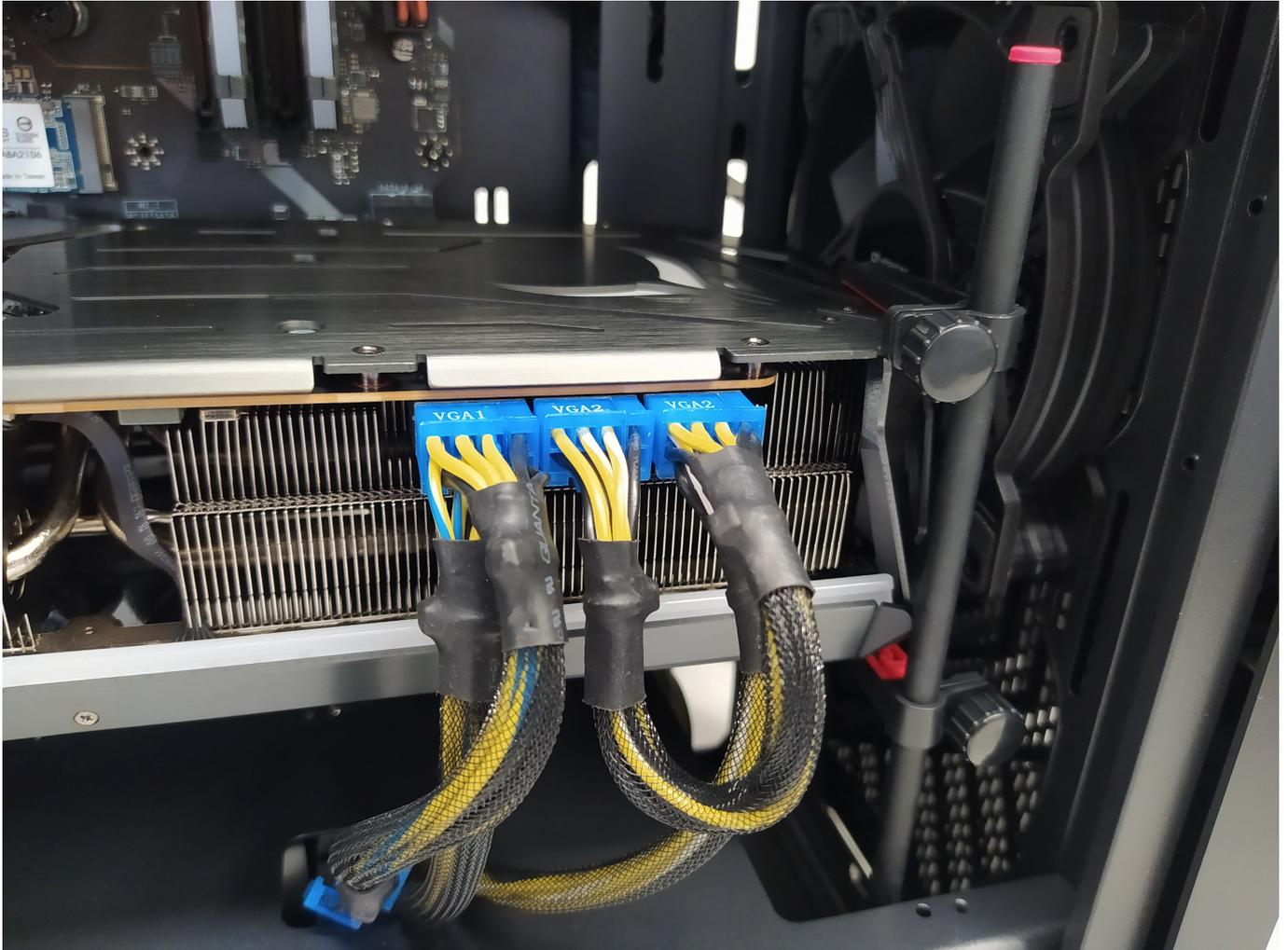
Bei der Positionierung achte bitte darauf, dass der Halter nicht die Lüfter der Karte berührt! Der Halter sollte möglichst am Ende der Karte angebracht werden.
