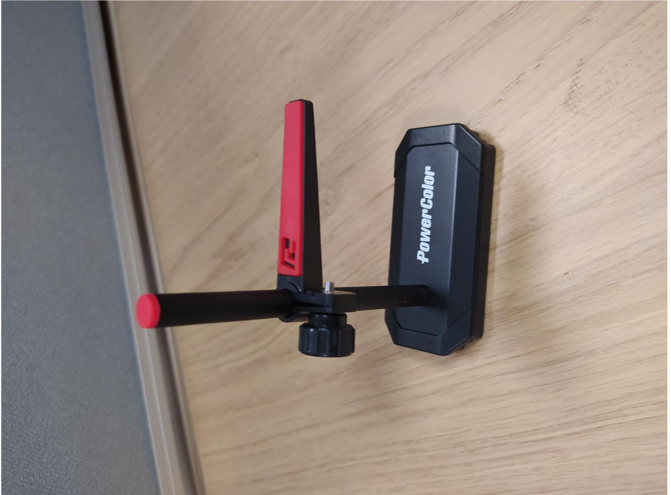
Bei einem Big Tower kannst du beide Stangen zusammenschrauben und wenn Du möchtest beide Halterungen verwenden, um die Grafikkarte von oben und unten zu fixieren. Achte darauf, dass die gummierte Seite die Grafikkarte berührt
