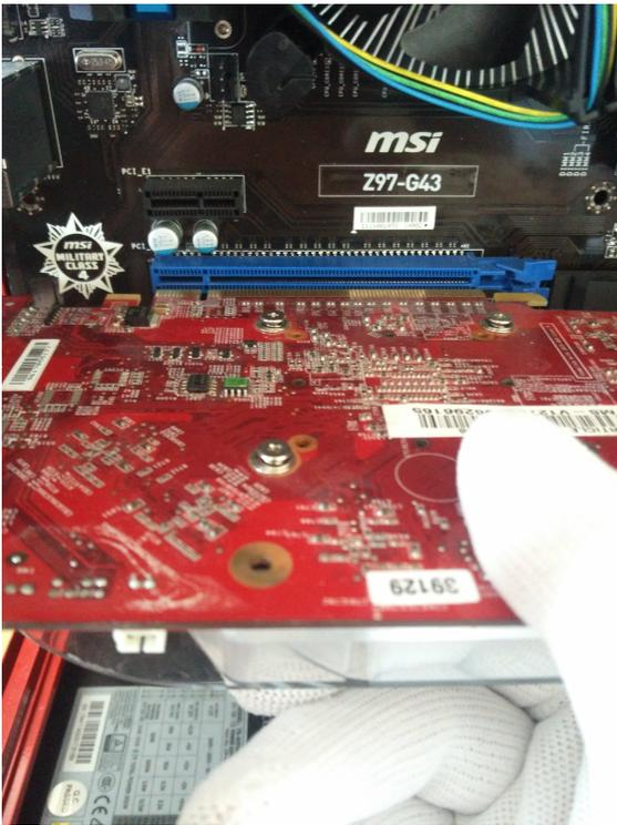
Wenn die Karte gelöst wurde, kann diese einfach aus dem Gehäuse gezogen werden.
