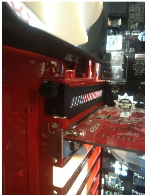
Jetzt wird die Grafikkarte nur noch durch den PCIe Slot und einer kleinen Nut im Gehäuse gehalten.
