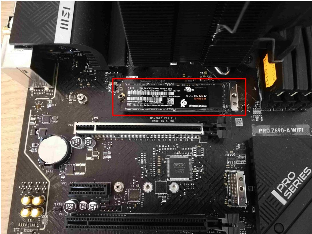
Um die M2 SSD auszubauen, müssen sie nun die Schraube am Ende der SSD lösen:
