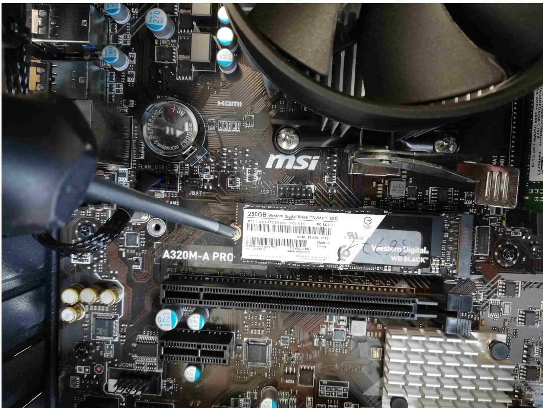
Ist die Schraube gelöst, kommt das Ende der M2 ihnen etwas entgegen und kann vorsichtig aus dem Slot gezogen werden.
