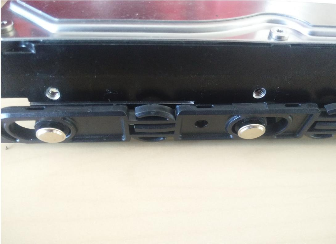
Die Bohrungen der Festplatte müssen auf Höhe der Metallstifte der Halterung liegen
