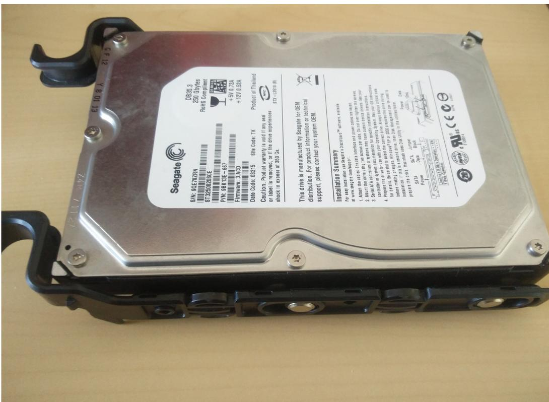
Ist die Festplatte in den Rahmen eingesetzt, werden die Metallstifte eingedrückt und die Festplatte somit gesichert. Die Festplatte ist jetzt für den nächsten Schritt vorbereitet.
