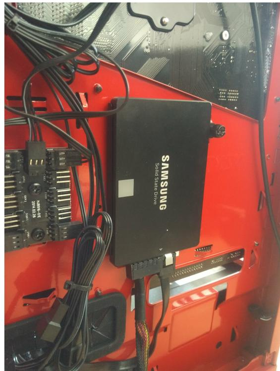
Nachdem noch der Stecker vom Netzteil und das SATA Kabel vom Mainboard angeschlossen sind, können Sie das Gehäuse schließen und mit der Einrichtung der SSD beginnen.
