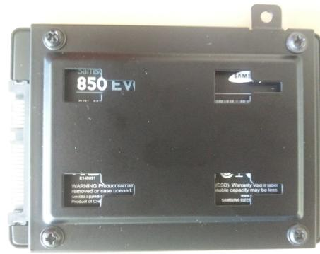
Jetzt kann der Einbaurahmen an den dafür vorgesehenen Punkt am Mainboardblech geschoben werden und mit der Schraube oben Rechts gesichert werden:
