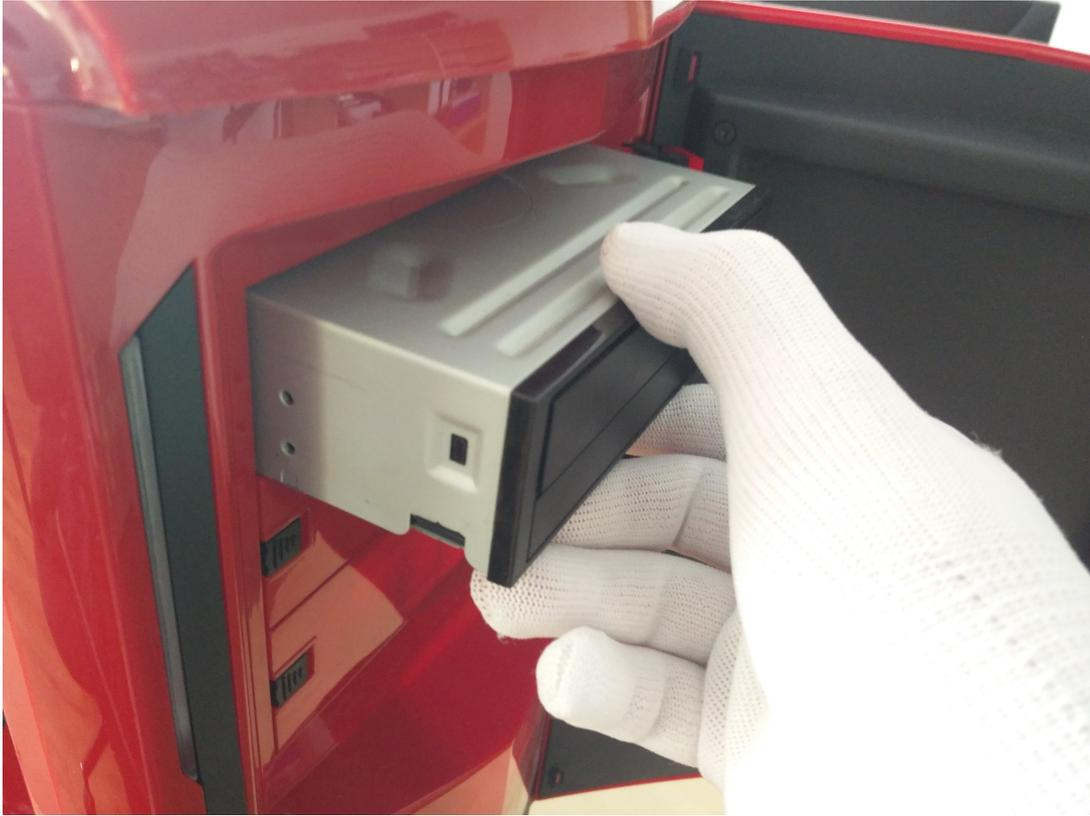
Für den Einbau des neuen Laufwerkes gehen Sie bitte in umgekehrter Reihenfolge vor.
