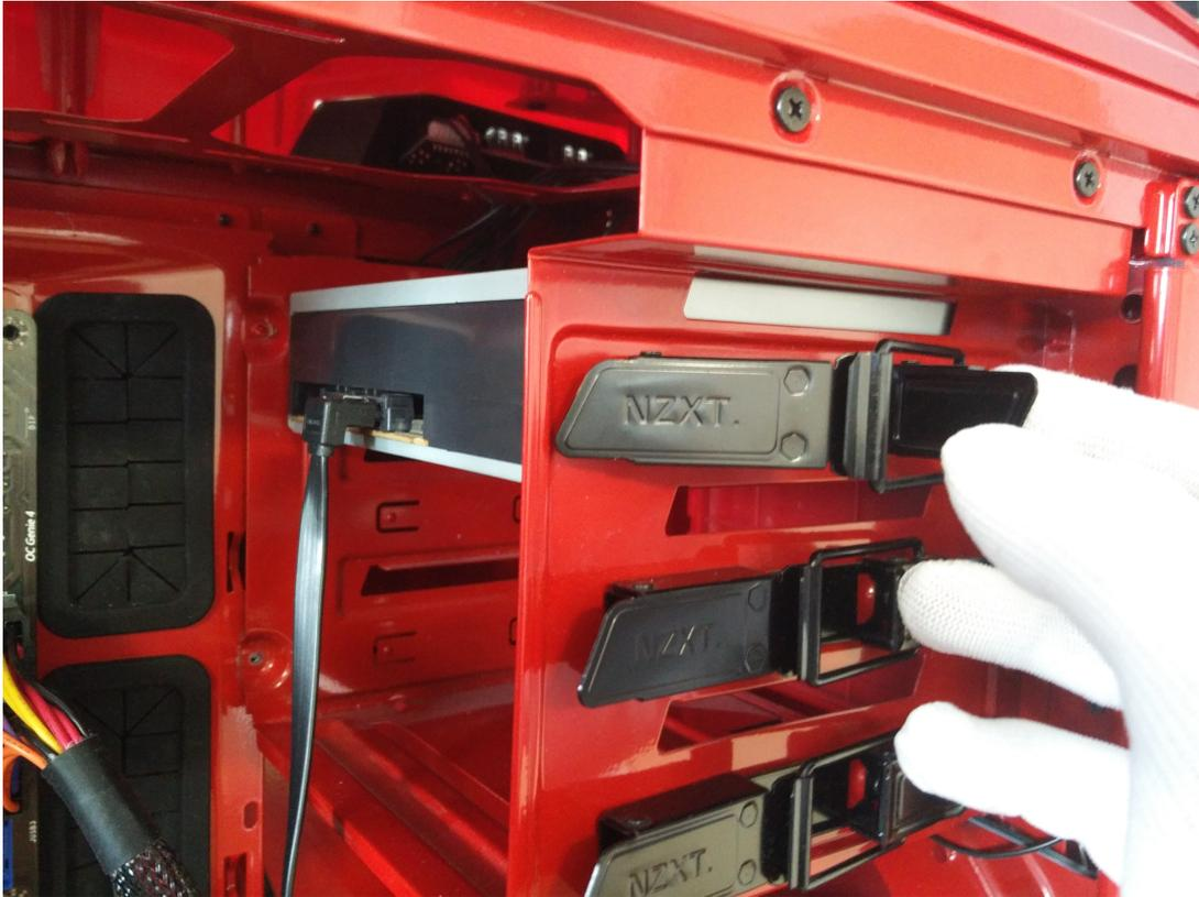
Bei diesem Gehäuse sind am 5,25" Laufwerkskäfig Schnellverschlüsse angebracht. Es werden verschiedene Arten von Schnellverschlüssen verwendet. Besitzt Ihr Gehäuse kein Schnellverschlusssystem, ist das Laufwerk im Normalfall mit dem Laufwerksrahmen verschraubt. In dem Fall lösen Sie die Schrauben an den Seiten des Laufwerkskäfigs.
