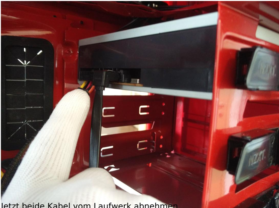
Jetzt beide Kabel vom Laufwerk abnehmen.
