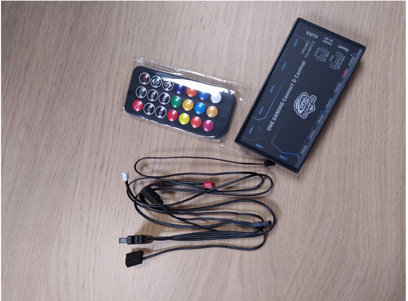
Damit die Steuerbox mit Strom versorgt werden kann benötigst Du als erstes das beiliegende Kabel mit dem roten kleinen Anschluß. Stecke dieses in die mit POWER beschriftete Buchse. Das Kabel passt nur in einer Richtung, also achte darauf es richtig herum einzustecken.
