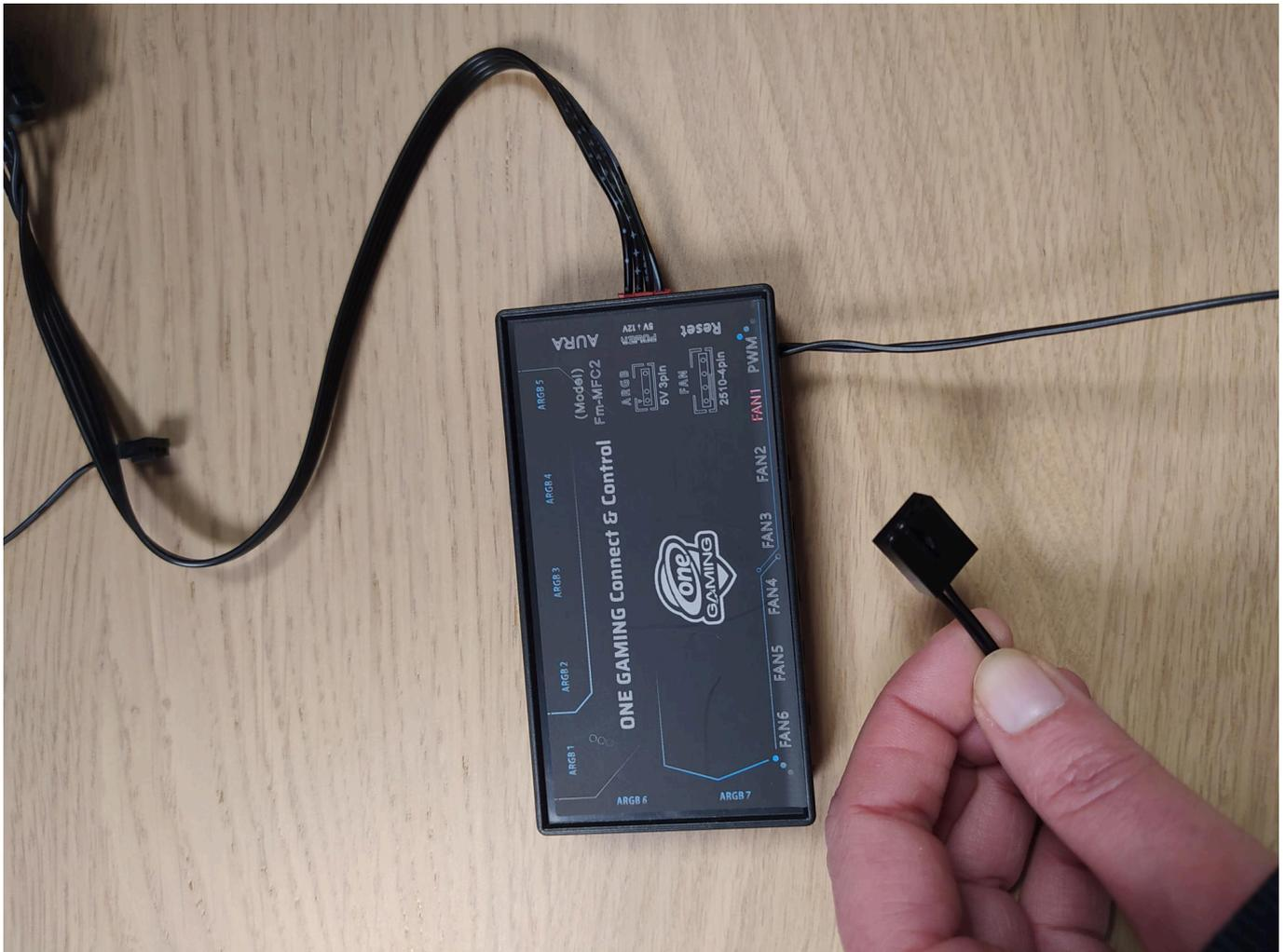
Das andere Ende des Kabels musst Du nun mit einem Fan Anschluß auf dem Mainboard verbinden, hier im Beispiel ist es SYS\_FAN5.
