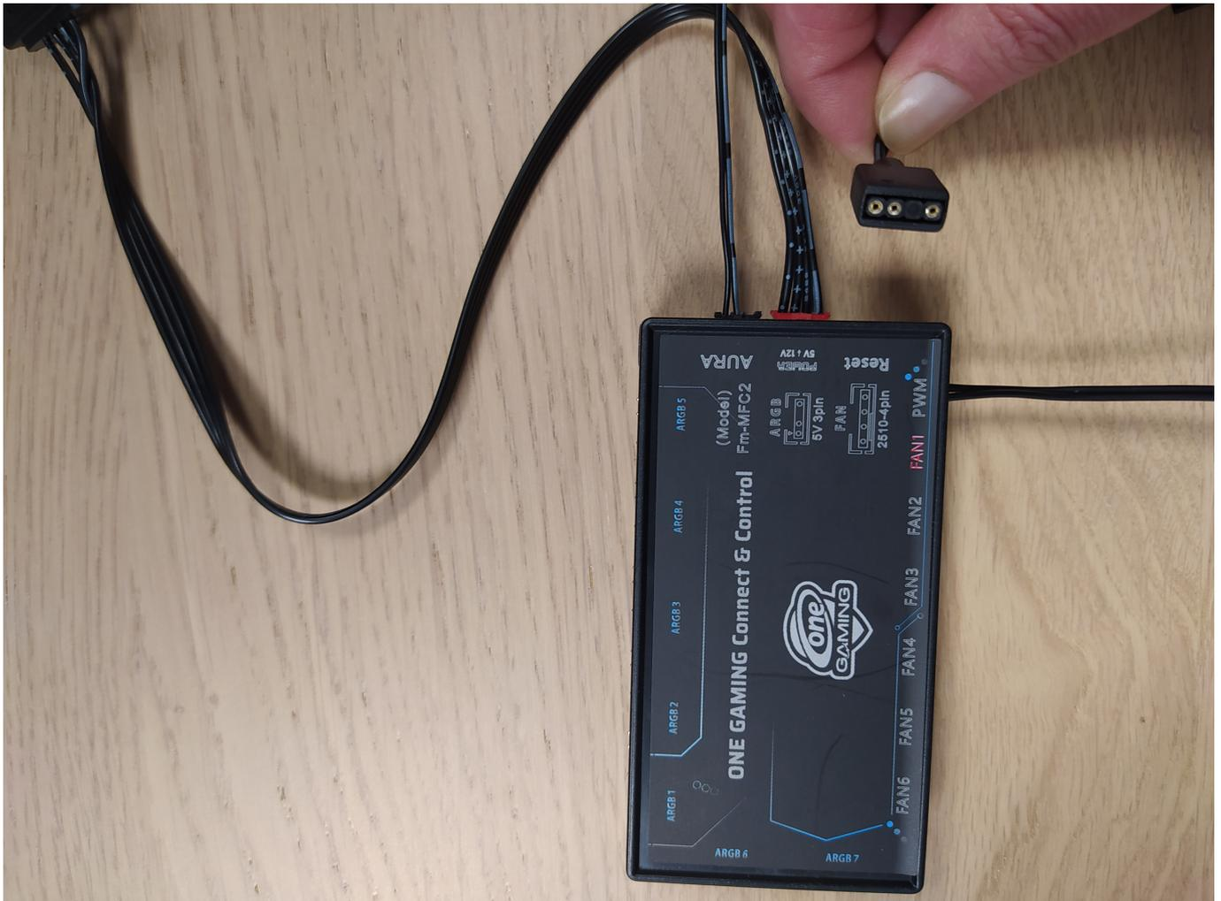
Das andere Ende muss nun mit einem passenden Anschluß auf dem Mainboard verbunden werden, auch hier hilft Dir das Handbuch des Boards weiter. In unserem Beispiel heisst der Anschluß JRAINBOW1.
