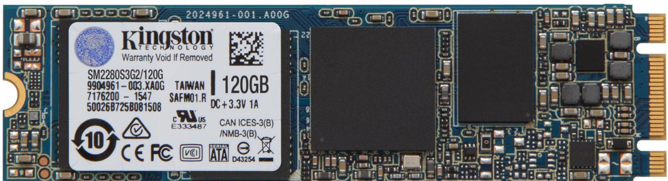
Ursprünglich wurde der Anschluss in Notebooks und Tablets verwendet, da die Spezifikation als besonders platzsparend gilt. Mittlerweile wird der Anschluss auch in Desktop-Computern eingesetzt, um SSDs (NVM Express) anzuschließen, da hier weit höhere Geschwindigkeiten erreicht werden können als bei herkömmlichen SSDs, welche über die SATA-Schnittstelle angebunden werden.
