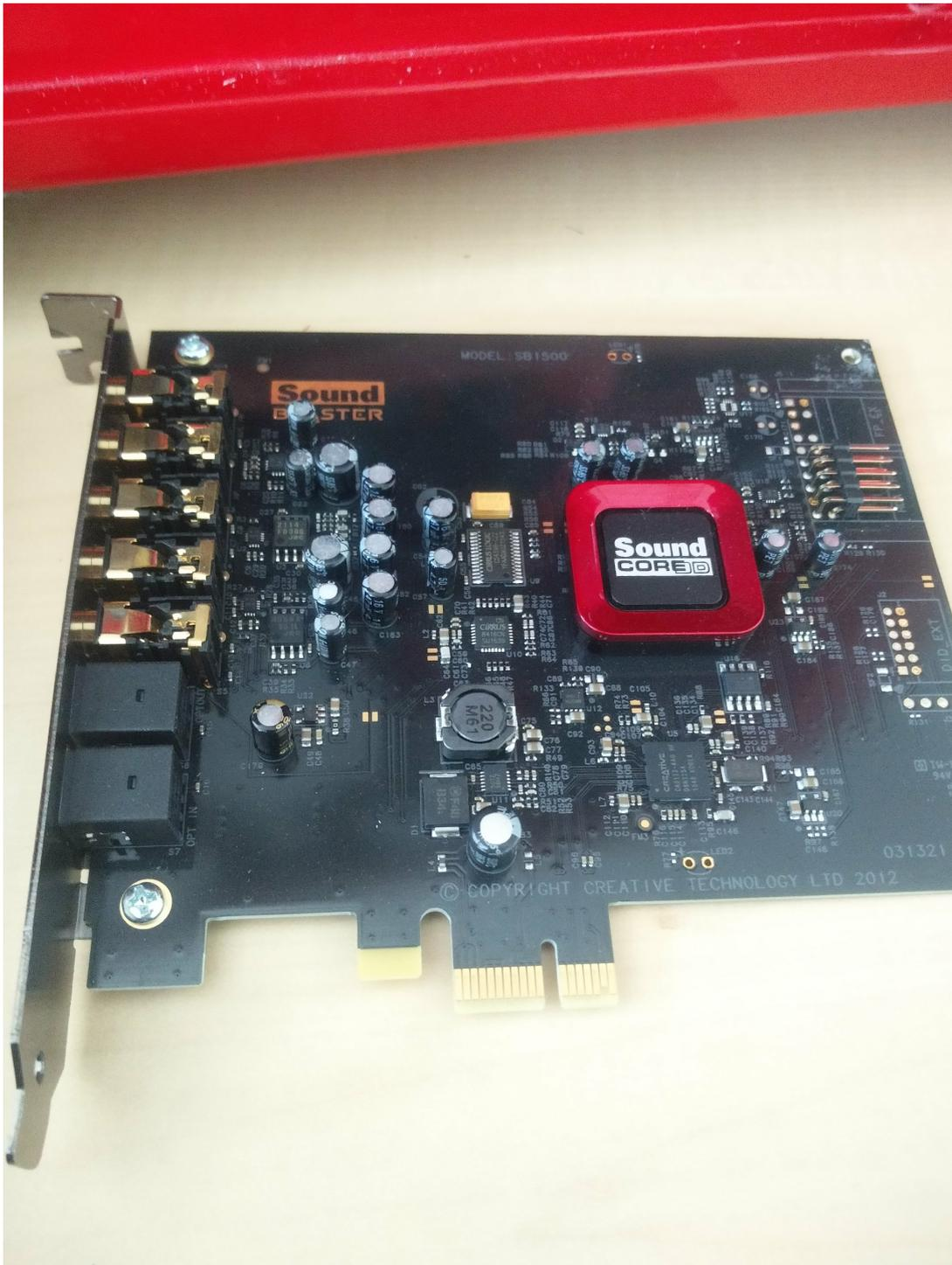
Diese Soundkarte wird in einen PCI-e 1x Slot gesteckt.
