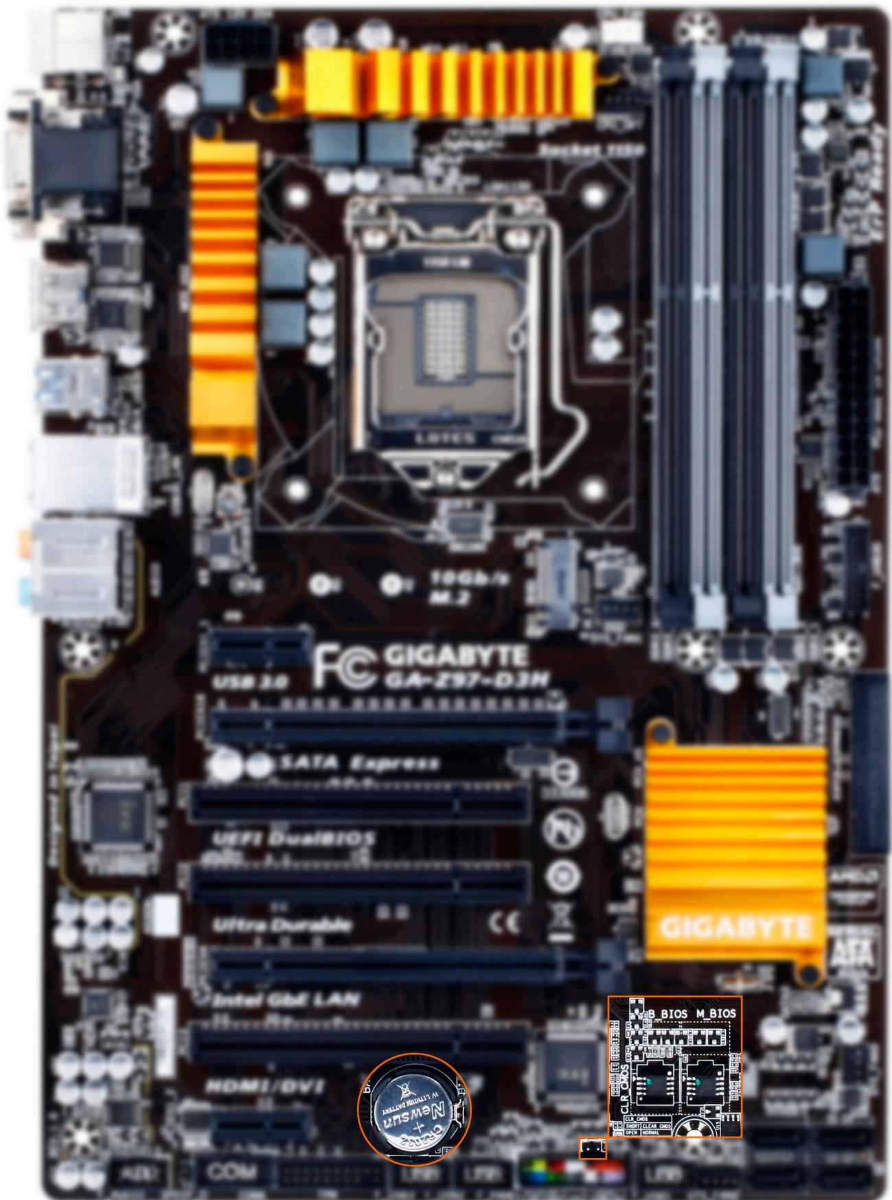
Bei dem oben angezeigten Mainboard handelt es sich um ein Modell mit 2 BIOS-Chips. Links unterhalb der beiden Chips sind die Pins für einen sogenannten BIOS-
