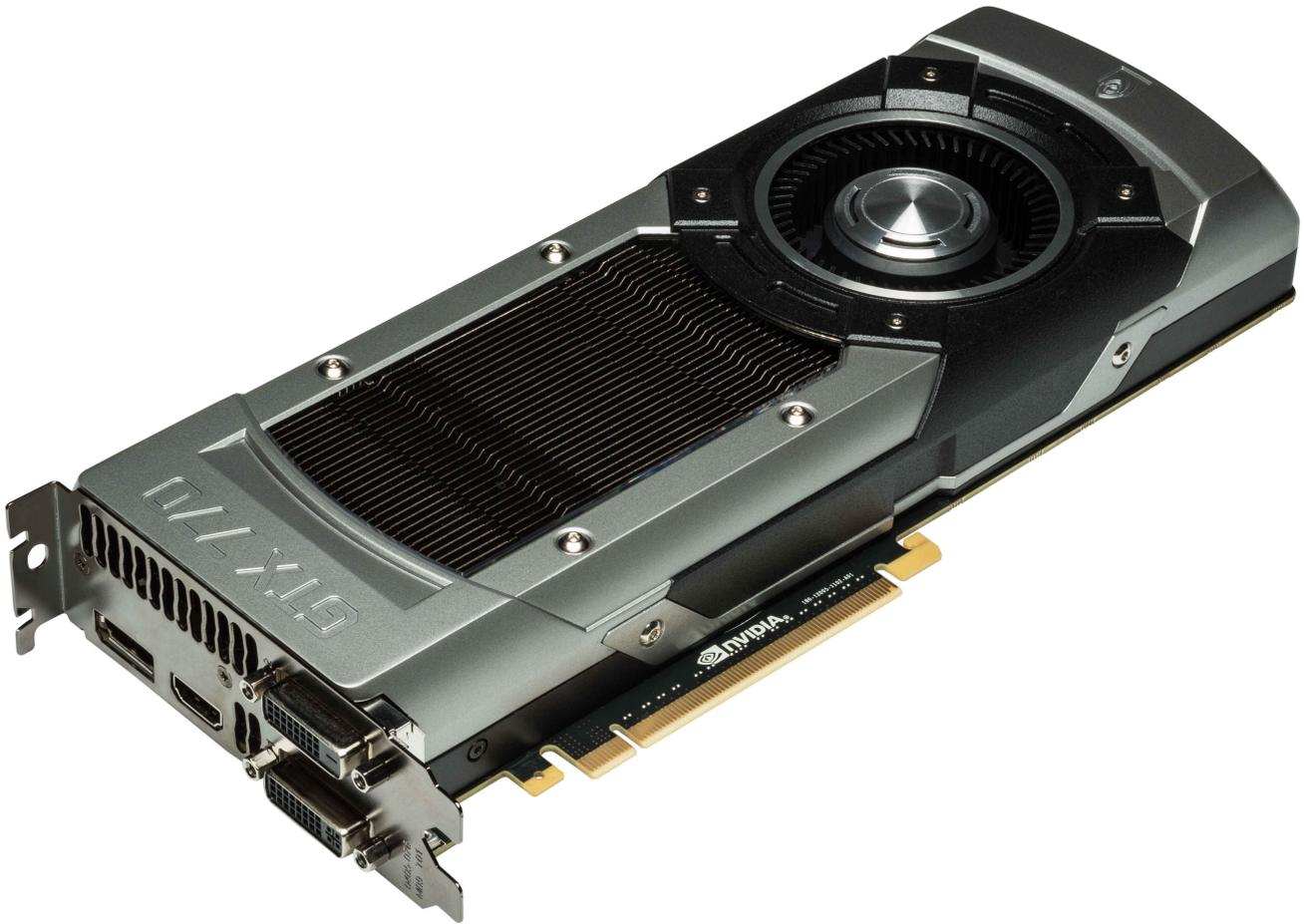
Eine gesteckte Grafikkarte kann grundsätzlich ohne Weiteres ausgetauscht werden. Man muss nur darauf achten, dass das Gehäuse genug Platz bietet und die Stromversorgung, welche bei Hochleistungsgrafikkarten über das Netzteil erfolgt, sichergestellt ist.
